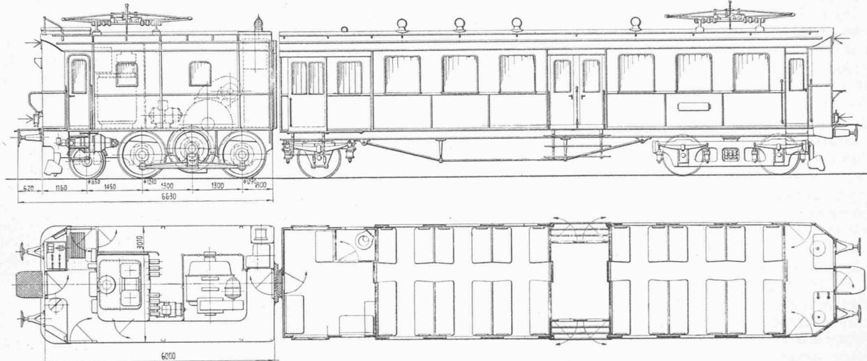
Abb. 2. Ansicht und Horizontalschnitt der neuen Motorwagen der Berner Alpenbahn, Maßstab 1:125. (Cliché der Maschinenfabrik Oerlikon.)
