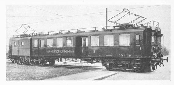
Abb. 1. Neuer Motorwagen CFe 2/16 mit getrenntem Triebgestell der Berner Alpenbahn, Bern-Lötschberg-Simplon.
