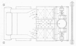
Abb. 3. Dampfkessel mit Vorwärmer und Lufterhitzer.
