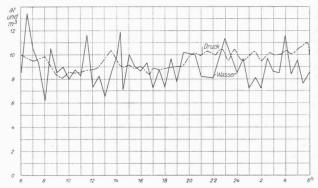
Abb. 5. Wasser- und Druckdiagramm von 2 Babcock- & Wilcox-Kesseln von je 450 m² Heizfläche und 10 at.
