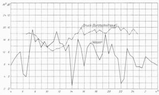
Abb. 4. Wasser- und Druckdiagramm von 13 Flammrohrkesseln von je 91 m² Heizfläche und 10 at.
