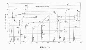
gener Spitze. Um durch die Hammerschläge beim Aufstellen der Prüfnadel keine Deformationen des Auflagerkopfes zu bewirken, wird eine passende Schlaghaube aufgesetzt und nach dem Eintreiben der Nadel bis zur Nadelkante wieder abgenommen.
