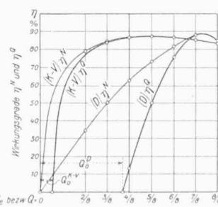
Die beigegebene Abbildung zeigt den Vergleich der Wirkungsgrade  $\eta^N$  und  $\eta^Q$  zweier Propellerturbinen nach Typ K-V und D (für letzteren siehe meinen Aufsatz), beide von  $n_s = 800$ . Welch gewaltiger Unterschied der beiden Typen, sobald deren Füllung unter etwa  $7/8 Q$  sinkt;  $Q_0$  bedeutet diejenige Wassermenge, mit der die Turbine erst anfängt, nutzbare Kraft abzugeben.
