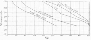
Abb. 1. Dauerkurven der minimalen Fahrwassertiefen der von 1907 bis 1913, bezw. 1921 regulierten Rheinstrecke Strassburg-Sondernheim, zur Veranschaulichung der fortschreitenden Verbesserung der Fahrwassertiefen und der damit erzielten Verlängerung der jährlichen Schiffahrtsdauer (vgl. Abb. 2).
