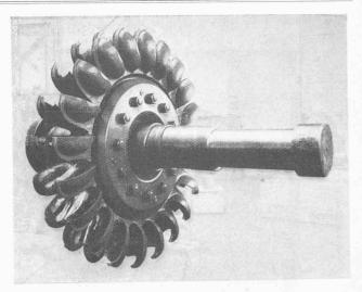
Fig. 2. Roue de la turbine Pelton de 10500 ch.
