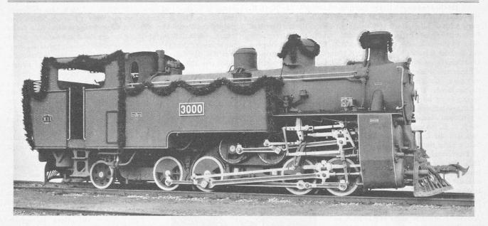
Die 3000. Lokomotive der Schweizer. Lokomotiv- und Maschinenfabrik Winterthur; Eine der kombinierten Adhäsion- und Zahnrad-Lokomotiven Klasse "X" der Nilgiri-Bahn (Vorderindien) mit 1000 mm Spurweite (Beschreibung in Band 70, Seite 75, 18. August 1917).
