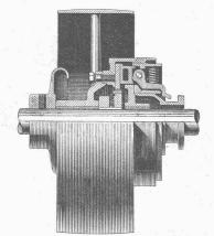
Benn-Kupplung, Typ NN, in Verbindung mit Riemenscheibe
