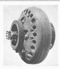
Abb. 10. Ansicht des Sekundärgetriebes.
