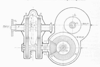
Abb. 6. Schema des gesamten Getriebes.
