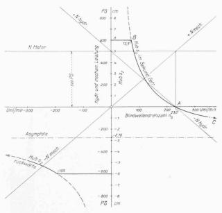
Abb. 11. Hub- und Leistungs-Charakteristiken des Schneider-Kolbengetriebes.
