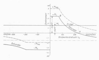
Abb. 12. Drehmomente an der Blindwelle des Zahnrädergetriebes.
