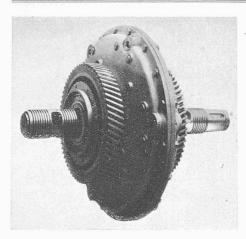
Abb. 9. Ansicht des Primärgetriebes.
