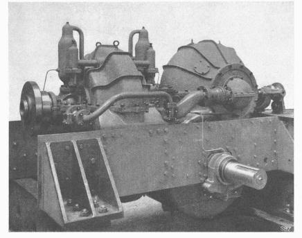
Abb. 1. Hydraulisches Kolbengetriebe System Schneider für 500 PS Uebertragungsleistung. Ausgeführt von der Schweizer. Lokomotiv- und Maschinenfabrik in Winterthur.
