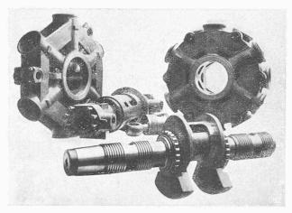
Abb. 8. Einzelteile des Primär- und des Sekundärgetriebes.
