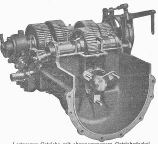
Lastwagen-Getriebe mit abgenommenem Getriebedeckel
