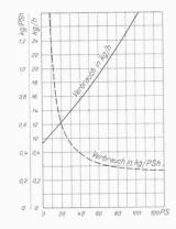
Abb. 5 und 6. Charakteristische Kurven des Saurer-Antriebmotors.
