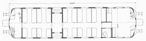
Abb. 2. Aufriss und Grundriss des Wagens Nr. 9912. - Masstab 1:100.
