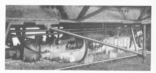
Abb. 7. Untergestell des Wagens Nr. 9911 mit Motor und dreistufigem Wechselgefriebe der A.- G. Ad. Saurer in Arbon.
