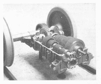
Radstand des Wagens als Lenkachse ausgebildet ist, frei folgen kann. Sämtliche Wellen des Getriebes lagern auf Rollenlagern, und eine vollständige Einkapselung des Getriebes verhindert jeglichen Oelverlust.
