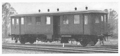
Abb. 1. Leichter Benzinmotor-Triebwagen der S. B. B. - Ansicht des Wagens Nr. 9911, Leergewicht 21 t.
