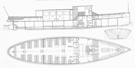
Abb. 1. Längsschnitt, Decksplan und Spantenriss. - Masstab 1:200.
