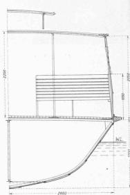
Abb. 2. Schnitt im Hauptspant. - 1:60.
