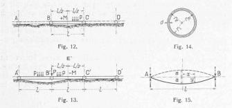
d'un dé la partie inférieure de chaque articulation. La conduite est ainsi surélevée et repose sur le sol uniquement par l'intermédiaire des dés. La sollicitation à la flexion qui résulte de ce dispositif est donnée par la figure 12.
