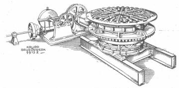
Drehrostentleerung für Zement-Schachtöfen
