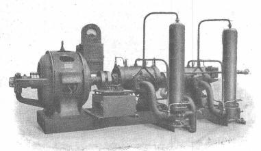
Leicht transportable Kompressoranlage für 5-10 Atm Druck.
