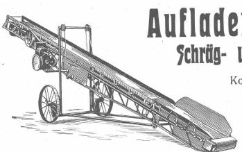
Auflader und Entlader Schräg- und Horizontal-Transporte
