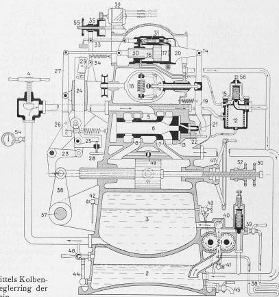
Abb. 17. Schema des Isodrom-Geschwindigkeits-Reglers, Bauart Bell & Cie., der Turbinen des Lungernsee-Kraftwerks.
