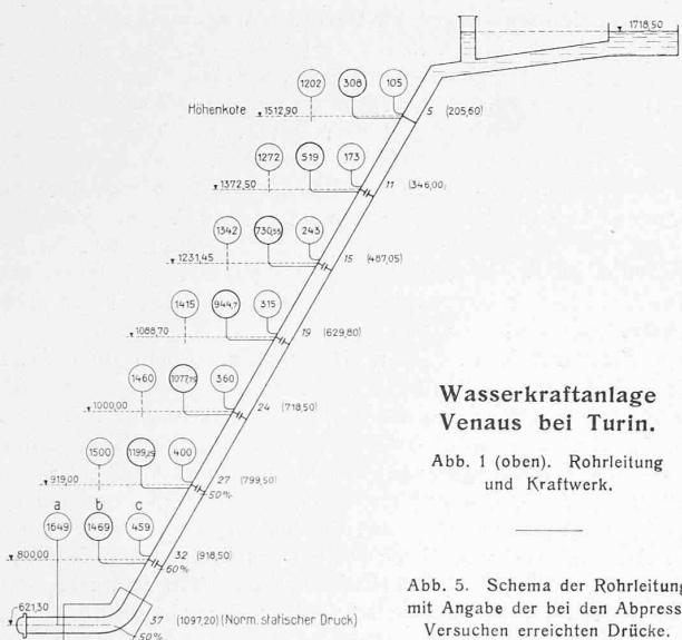
Abb. 1 (oben). Rohrleitung und Kraftwerk.
