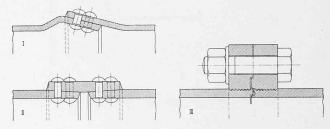
Abb. 4. Muffen, Laschen- und Flanschenverbindungen der Rohrleitung.
