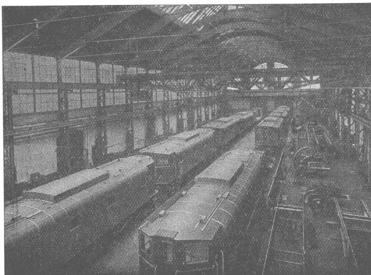
Lokomotiv-Montagehalle mit elektrischen Lokomotiven für Südafrika
