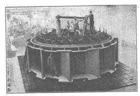
Une des turbines de Chancy-Pougny (Suisse) Puissance 8700 CV, sous 9 m de chute
