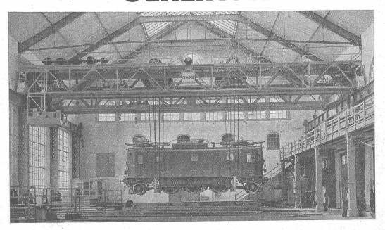
120 Tonnen-Laufkran in der Lokomotiv-Reparaturwerkstätte der S.B.B. in Zürich-Altstetten
