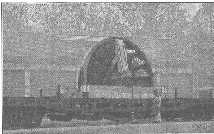
Lauftrad von 4,30 m für Anlage Parahyba (Brasilien) versandbereit.
