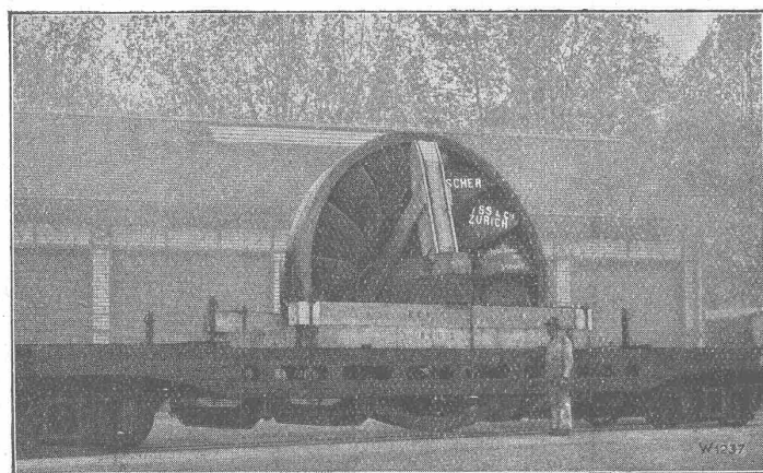
Lauftrad von 4,30 m für Anlage Parahyba (Brasilien) versandbereit.
