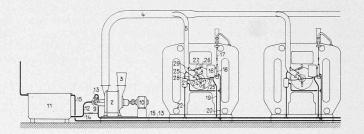
Abb. 30. Schema einer Sulzer-Oelfeuerung für grosse Heizanlagen.
