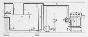
Abb. 24. Schema einer Sulzer-Oelfeuerung für kleinere Zentralheizungen.
