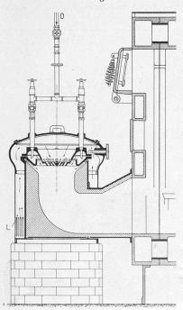
Abb. 19. Oelbrenner Bauart Becker.
