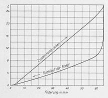
Abb. 2. Diagramm der Feder-Bewegungen bei Stoss und Rücklauf.
