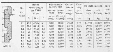
$P_0$  ist die elastisch aufgenommene Axialkraft. Es ist dann weiter  $\frac{P}{P_0} = \frac{\lg \alpha + \varphi}{(1 - \varphi \lg \alpha) \lg \alpha}$  bezw.  $P_0 = P \frac{\lg \alpha (1 - \varphi \lg \alpha)}{\lg \alpha + \varphi}$
