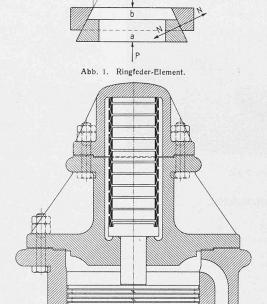
Abb. 3. Ringfeder-Kolbenfang für Dampfhämmer.
