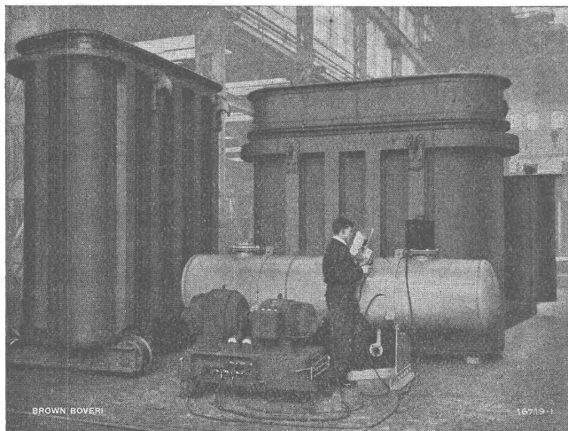
Mit Brown Boveri Lichtbogen-Schweißgruppen elektrisch geschweißte Groß-Transformatorenkessel.
