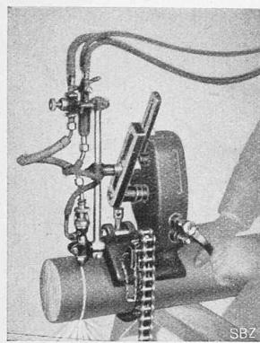
Welle geschieht durch Verschieben eines Führungssteines in dem unteren Arme des Hauptparallelogramms. An einer dort angebrachten Skala sind die der jeweiligen Brennerstellung entsprechenden Wellendurchmesser verzeichnet. m.
