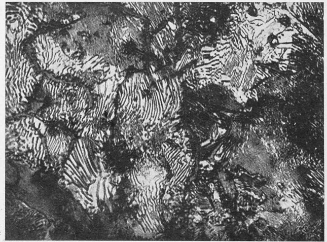
Abb. 5. Perlitguss. 150-fache Vergrösserung.
