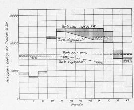
Abb. 1 und 2. Wirkungsgrade und verfügbare Leistungen zweier Kraftwerke zwischen 50 und 100 m Gefälle, mit Turbinen im neuen Zustande und in verschiedenen Stadien der Abnützung.
