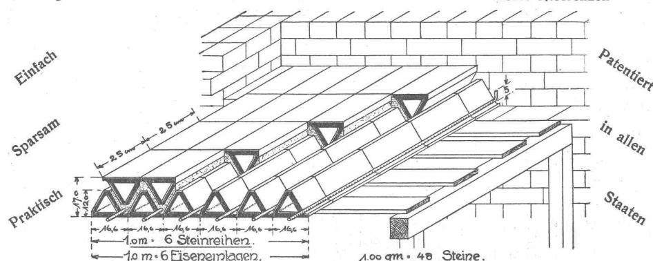
Die durch die Steinform hervorgerufene Gitterträger-Anordnung des Tragkörpers ermöglicht grosse Ersparnis an Eisen und Beton und schafft dadurch die Möglichkeit der doppelten Höhlkörperlage in der Decke.
