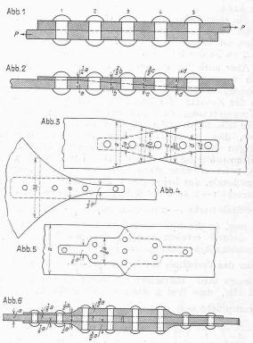
Abb. 1. Uebliche Nietverbindung (aus Förster, "Taschenbuch für Bauing.").
