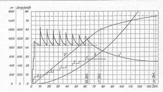
Abb. 10. Anfahrverhältnisse des Ce 4/6 Motorwagens Nr. 9801; links leer (79 t) auf  $0^{\circ}l_{00}$ ; in der Mitte mit 150 t auf  $0^{\circ}l_{00}$ ; rechts mit 150 t auf  $10^{\circ}l_{00}$ . J = Strom pro Triebmotor, v = Geschwindigkeit, s = Anfahrweg, gestrichelte Linie = Anfahrstufen. — Zeit von Beginn der Drehung der Fahrkurbel an gerechnet.
