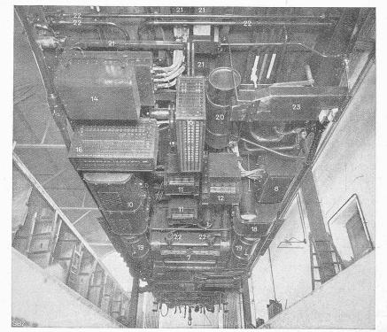
Abb. 5 Anordnung der elektrischen Apparate unter dem Wagenboden (Untersicht).
