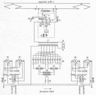
Abb. 6. Schaltungschema von Hochspannung- und Triebmotoren-Stromkreis.
