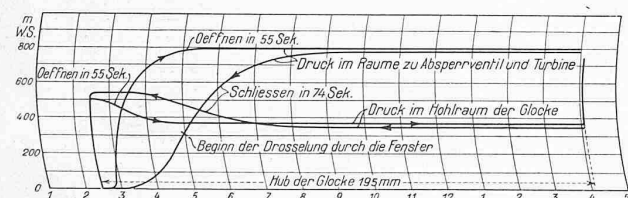
Abb. 54. Druckveränderung im Absperrventil Nr. 4 bei Öffnen und Schliessen. Nadelhub für Öffnen = 10 mm, für Schliessen = 120 mm; Durchmesser der Blende = 3,5 mm.
