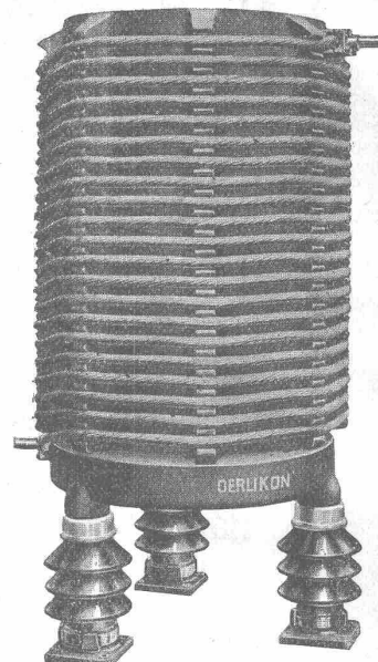
Prüfspannung unter 4 mm Regen: 50 000 Volt. Nennstrom 800 Amp. Induktivität 0,2 MH.
