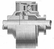
Benn-Kupplung, Typ NN, zur Verbindung zweier Wellen
