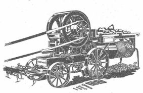
Fahrbarer Steinbrecher mit Sortiertrommel
