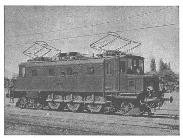
Einphasen-Schnellzuglokomotive mit Einzelachsantrieb Bauart Brown Boveri, Type 2C1. für die Schweizerisehen Bundesbahnen.
