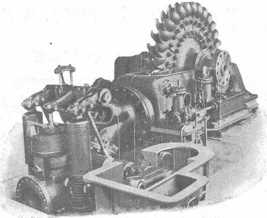
3 Hochdruck-Pelton-Turbinen von je 17000 PS Leistung bei 720 m Gefälle und 333 Umdrehungen per Minute für das SBB Kraftwerk Barberine (Wallis) geliefert.
