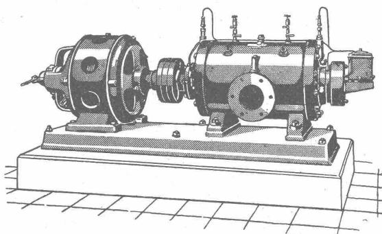
Direkte Kupplung mit Elektromotoren oder Riemenantrieb
