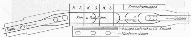
Abb. 16 u. 17. Betonzubereitungsanlage. Grundriss 1:900 und Schnitt 1:500.
