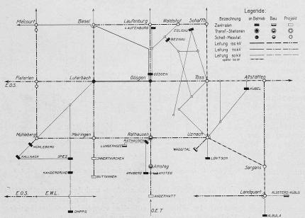
Abb. 1. Generelles Schema des Netzausbaues der "S. K." und anzuschliessender Werke. (Heute besteht auch eine noch nicht eingezeichnete Verbindung Brusiowerk-Albulawerk.)
