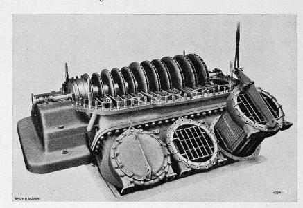
Abb. 4. Turbokompressor, Bauart BBC, für grosse Leistung. Oberteil abgenommen.
