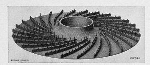
Abb. 1. Schaufelrad eines BBC-Turbokompressors.
