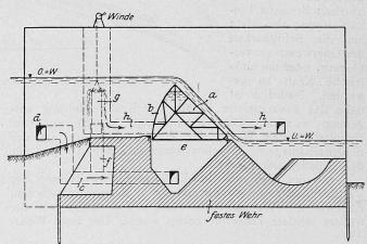
Abb. 3. Schematischer Querschnitt des Wehrs.
