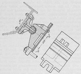
Abb. 5. Drucklager der Sektorschützen. - 1:6.
