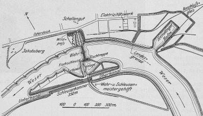
Abb. 1. Lageplan des Weserwehrs bei Bremen. - Masstab 1:15000.
