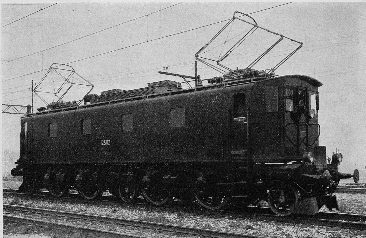
Abb. 1. Einphasen-Schnellzug-Lokomotive 1-B-1+B-1, von 2400 PS Stundenleistung, der Schweizerischen Bundesbahnen.
