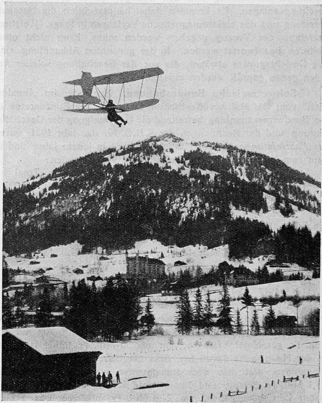
Abb. 5. Das Doppeldecker-Gleitflugzeug von Pelzner im Flug.
