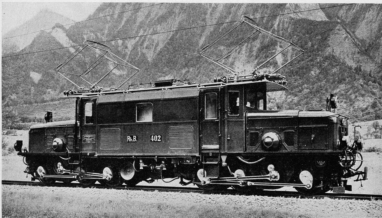
Abb. 17. C-C-Schmalspur-Lokomotive der Rhätischen Bahn. — Dauerleistung 1000 PS, Stundenleistung 1200 PS, max. Fahrgeschwindigkeit 45 km/h.
