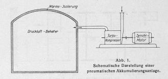
Eine solche pneumatische Akkumulierungsanlage ist in Abbildung I schematisch dargestellt. Sie besteht im wesentlichen aus einem wärme-isolierten Druckluftbehälter, in den der durch einen Synchron-Motor angetriebene Turbokompressor Luft komprimiert. Dieser Kompressor ist mit einer besonderen Regulierung versehen, die es erlaubt, ihn auch als Luft-Turbine arbeiten zu lassen, zum Antrieb des nunmehr als Generator laufenden Synchron-Motors.
