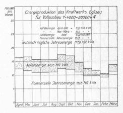
Abb. 3. Energieproduktion Eglisau bei Vollausbau.
