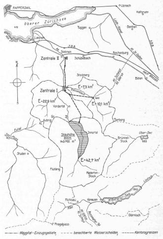
Abb. 4. Die Einzugsgebiete des Kraftwerks Wäggital. - 1:200 000.
