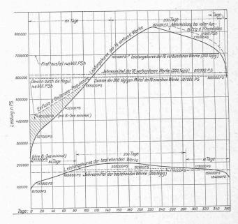
Abb. 23. Graph. Darstellung der Kraftnutzung nach Entwurf Mr. 6.
