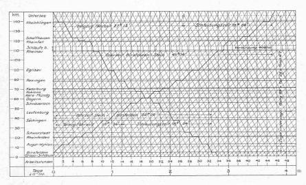
Abb. 24. Graphischer Schleppzug-Fahrplan für Maximalleistung nach Entwurf Nr. 6.
