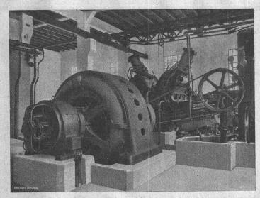
Antrieb eines Holzschleifers durch einen 600 PS Synchron-Induktionsmotor für Dreiphasenstrom, 500 V, 50 per/sec, Drehzahl 500,  $\cos \varphi = 1$
