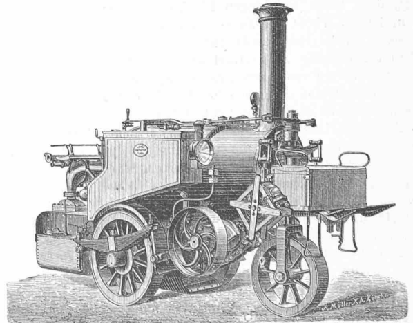
Strassenlokomotive (gleichzeitig als Dampffeuerspritze ausgebildet) für 15 t Zuglast bei rund 6 km/h Fahrgeschwindigkeit, mit der ihr Erbauer, Ing. Albert Schmid, im Jahre 1878 von Zürich nach Paris fuhr.
