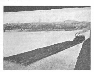
Abb. 5. Kohlen-Schleppzug im kanalisierten Ohio  $3 \times 3$  Kähne mit total rund 5000 Tonnen Ladung.
