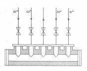
Abb. 12. Mischer für Wasser von verschiedenen Temperaturen.
