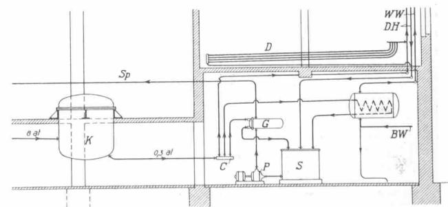
Abb. 11. Dampfausnutzung in zwei Stufen in einer Vulkanisieranlage.
