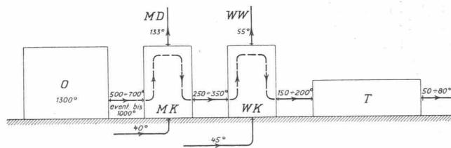
Abb. 10. Anlage mit möglichst weitgehender Benutzung der Wärme in drei Stufen.
